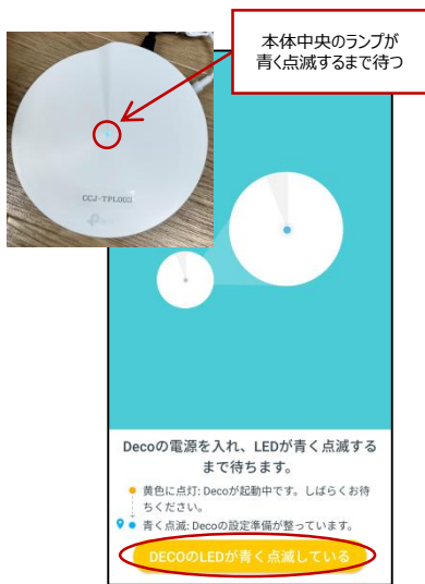
7. 本体中央のランプが青く点滅したら【DECOのLEDが青く点滅している】を選択する
