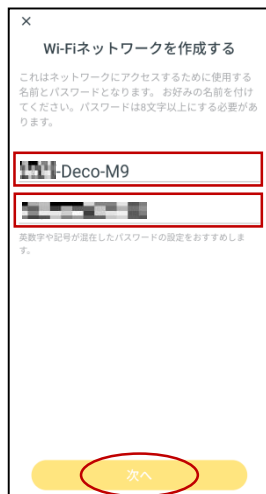
14. お客様で決めて頂いたSSIDとパスワードを入力し【次へ】を選択する
