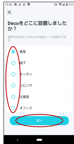
9. 子機の設置場所を選択し、【次へ】を選択します
